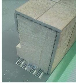
加工側の底面にジョイント用金具を刺し、接着する。
